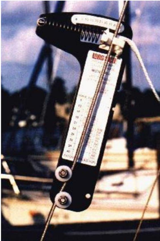
Le principe consiste à "tordre" légèrement le câble avec une certaine force et à mesurer la quantité de déformation produite.
